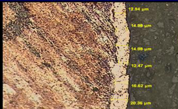
Sezione metallografica Strato di nichel su alluminio
